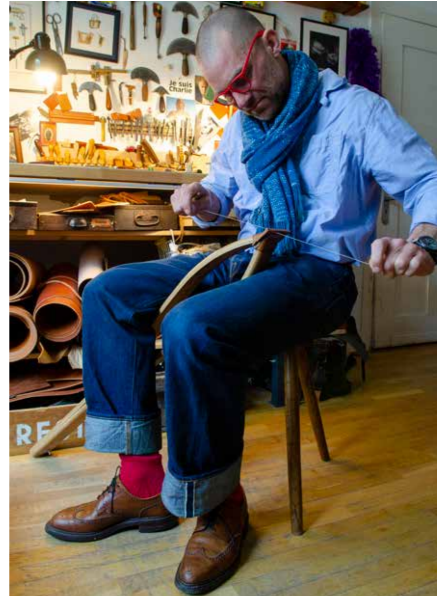
Alexander von Bronewski fertigt die Sattlernähte selbst von kleinen Geldscheinmappen auf dem Nähkloben an. Geschickt zieht er dafür den vorher eingewachsenen Zwirn durch zwei Löcher, verknottet ihn und zurtzt ihn fest.
